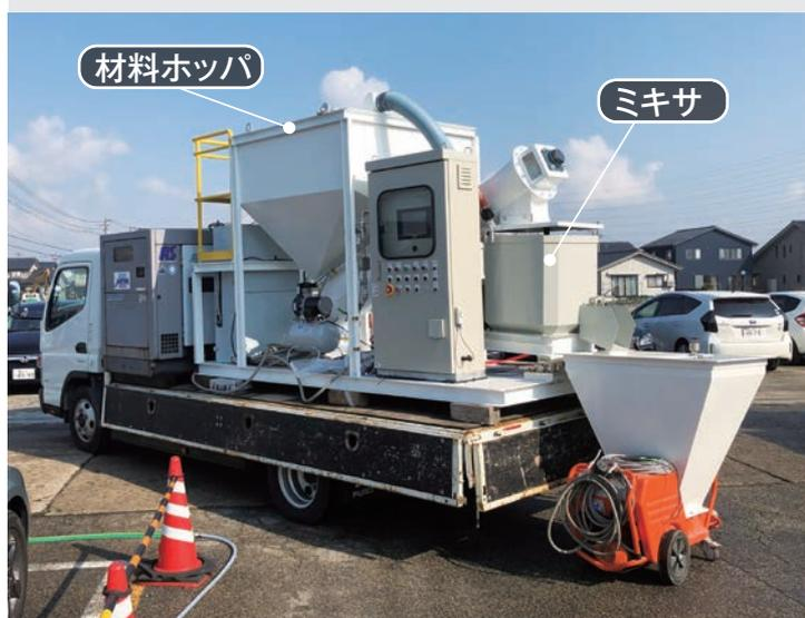
デンカB-MIXは、自動計量システムを採用した、バッチ型モルタル練りシステムです。
